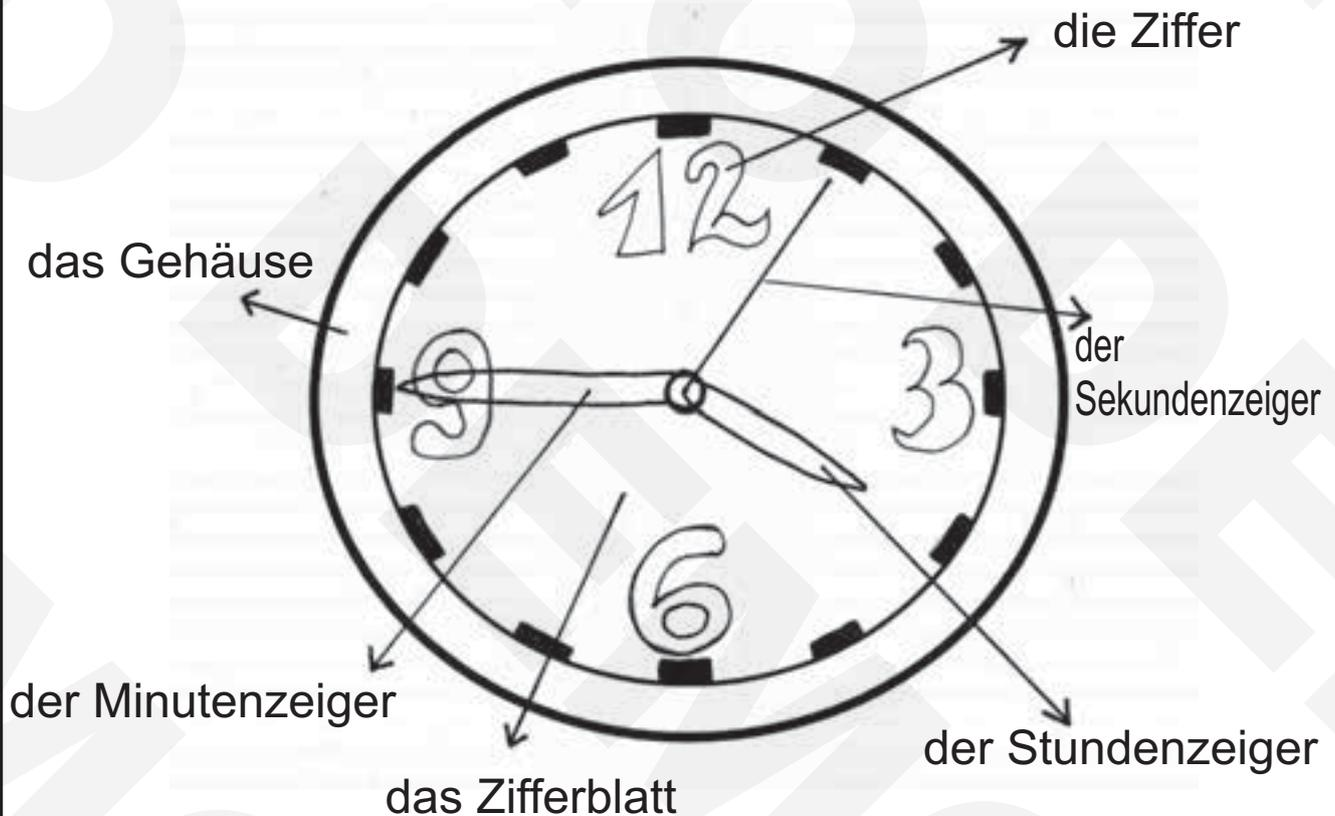
Die Uhr besteht aus dem Gehäuse, dem Zifferblatt, den Ziffern, dem Stundenzeiger und dem Minutenzeiger. Im Inneren des Gehäuses befindet sich das Uhrwerk. Es ist von außen nicht zu sehen. Manche Uhren haben auch einen Sekundenzeiger. Auf der Rückseite sieht man zwei Stellschrauben. Mit der einen Schraube kann man die Zeiger bewegen, um die Uhrzeit einzustellen. Die andere Schraube dient dazu, das Uhrwerk aufzuziehen.
